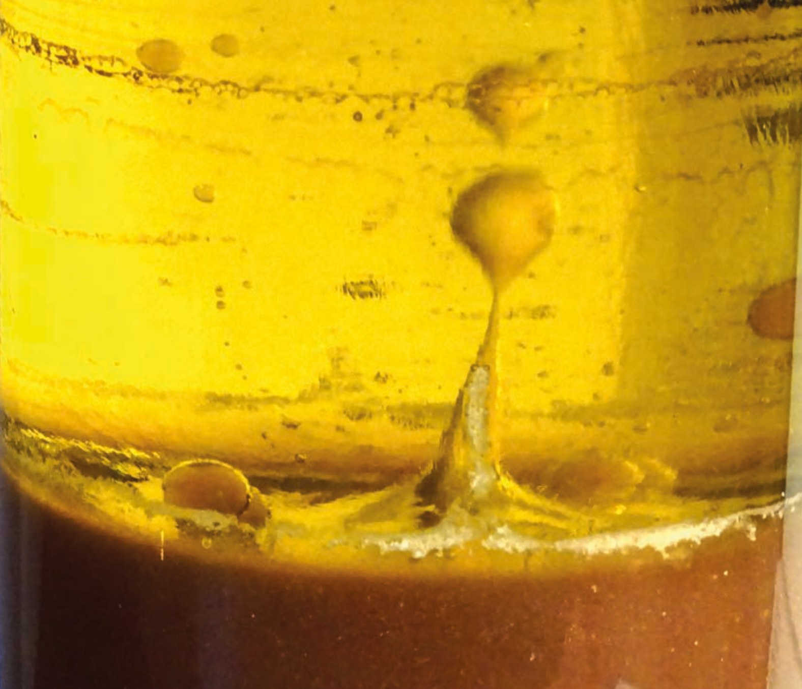
Pękają bąbelki, piana zanika, powstaje „deszcz” wodny w oleju, kropelki lokalnie łączą się w większe, stąd spadające ciemne kule... (fot. Wojciech Dindorf)
